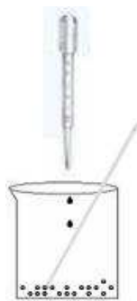
FIGURA 2 – DESENHO DO DISPOSITIVO EMPREGADO PARA DETERMINAÇÃO DO PONTO ÚMIDO.
